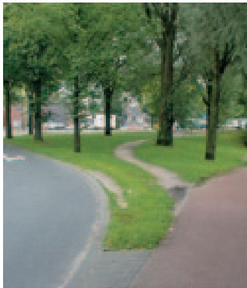
Un volumen menor a 100 peatones por hora por metro de ancho del perfil, permite la plena integración, sin una infraestructura especial. Entre 100 y 200 los peatones por hora por metro de ancho del perfil, recomendamos una separación. Para hasta 160 peatones, será suficiente una separación visual (uso de material, demarcaciones). Para más de 160 peatones, recomendamos un cauce especial para el ciclotráfico.
